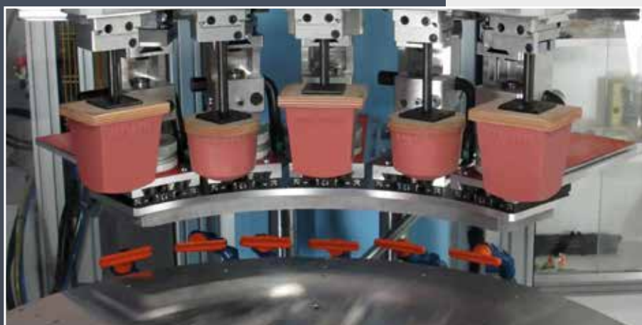
Esempio di un allestimento a 5 colori radiali, con tavola rotante a controllo numerico
