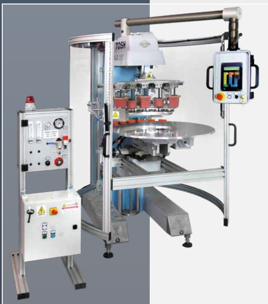
Logica 05 S a 5 colori radiali con tavola rotante e dispositivo di trattamento superficiale a mezzo flammatura.
