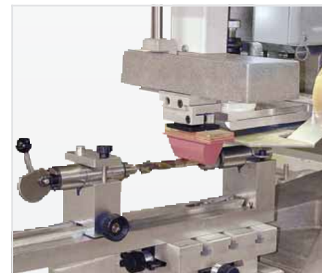
Reciprocatore tamponi SE 76 per stampa a rotolamento su Logica mi.micro Shuttle system SE 76 for rolling printing fixed on Logica mi.micro
