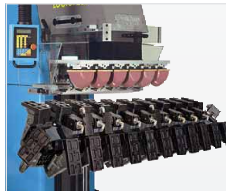
Convogliatore MEM 30°-144 su Logica 200 Conveyor MEM 30°-144 fixed on Logica 200
