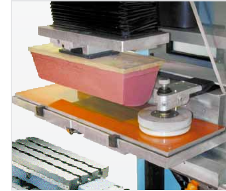
Dispositivo di ractura a rinfresco RTE 990 e tavola ortogonale TO 201 su Logica 08 Doctoring refresher system and cross table TO 201 fixed on Logica 08
