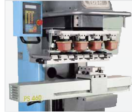
Indexore PS 460 e tavola ortogonale TO 100 su Logica 150 Indexer PS 460 and cross table TO 100 fixed on Logica 150
